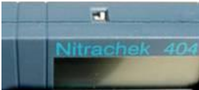
Schiebeschalter (Ein/Aus) für akustisches Signal
