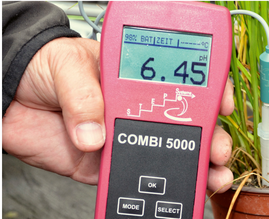
Die pH-Wert-Messung erfolgt mittels einer gelgefüllten pH-Einstichelektrode.
